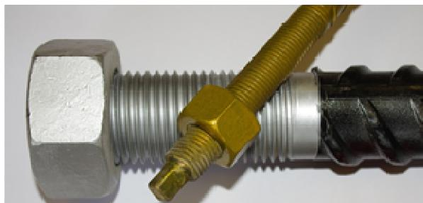
☹ La résistance du filetage est inférieure de 15 à 30% à celle du corps de la tige
