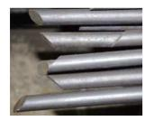
✓ Schrägschnitt der Stangen, oder konkav zum Rühren der Ausfugmasse
