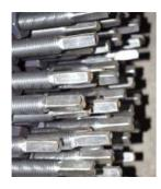
Vierkantantrieb oder Abflachung zum Rotieren der Stange
